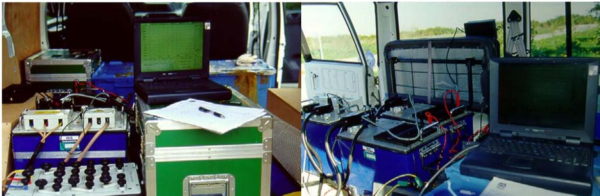
*Instrumentación NUMIS PLUS instalada en el interior de un vehículo de campo*
